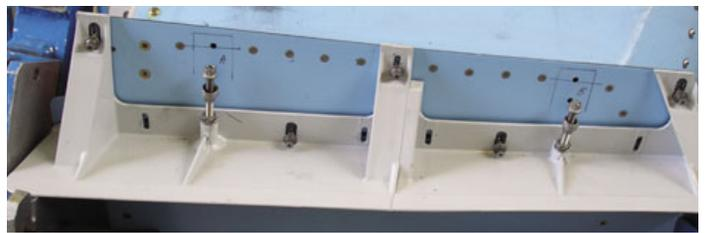
用 VICTREX PEEK 聚合物材料制成的吊架整流罩 (承蒙 Aircelle SAFRAN 集团公司提供图片)
