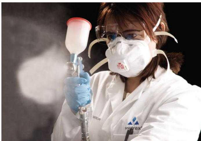
700粉末系列与 800喷剂系列。这些涂料可应用于大多数铁金属和非铁金属，无需使用底漆。VICOTE 涂料有黑色、灰/黑和米黄色几种，可用传统静电粉末涂装和液体喷涂设备涂覆。
