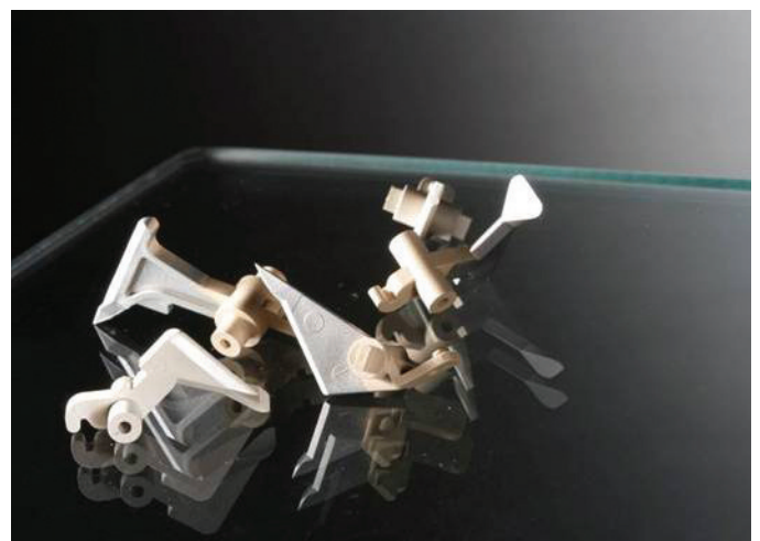
VICTREX HT™ 聚合材料在打印机指叉中替代用含氟聚合物喷涂的金属，无需二次处理，即可在摩擦环境中获得出色的耐高温性能。
