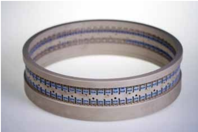
就像这个电镀环上所看到的那样，压塑成型零件上可能要进行机械加工等二次加工。
