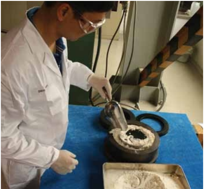
必须用适量的VICTREX PAEK粉末小心充填清洁的模具。
