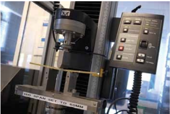
可进行弯曲性能测试来监测压塑成型件的质量。
