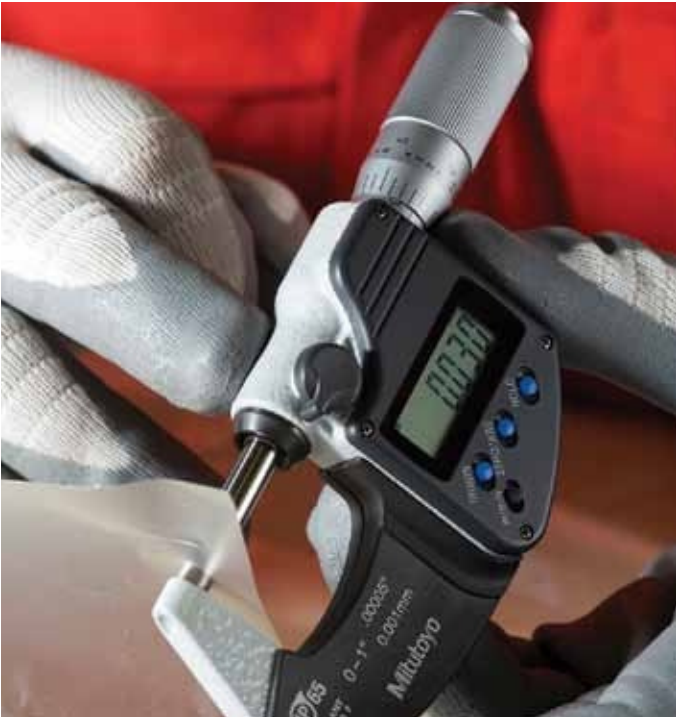
测量挤出APTIV PEEK膜的厚度。
