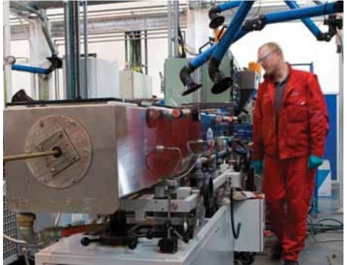
合适的下游设备使加工能够进行定制, 以获得要求的结晶度。
